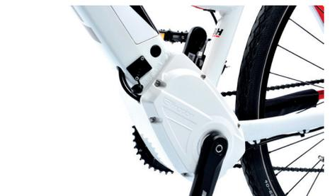
Aufgerichteter Brose Motor und Außenladebuchse am Unterrohr.
